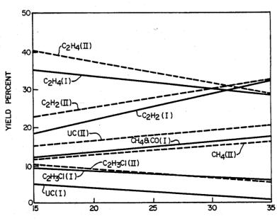
DISTANCE ALONG REACTOR FROM INJECTION POINT, CM.
