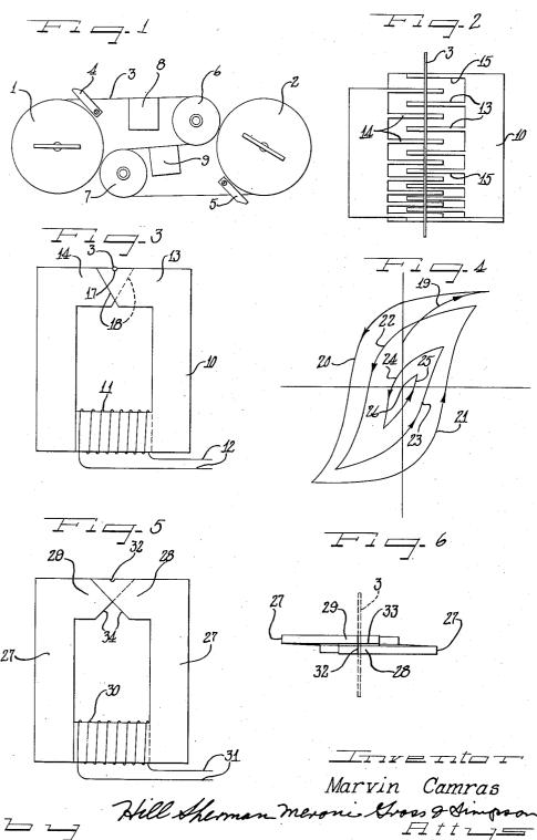
RECORDING AND ERASE HEAD FOR MAGNETIC RECORDERS
