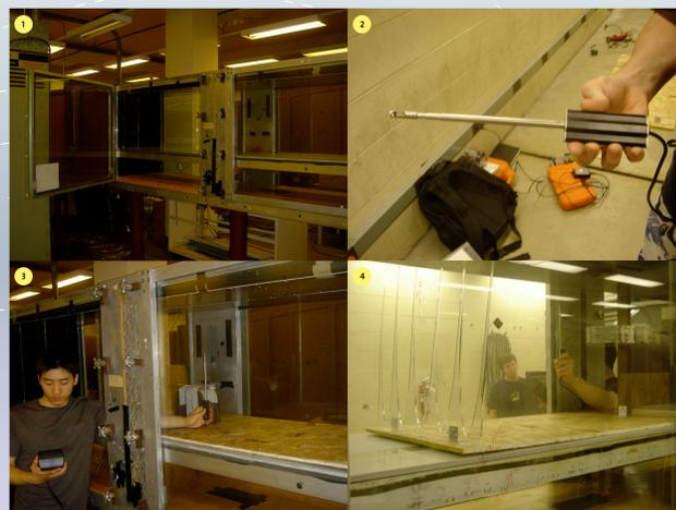
1. HIGH SPEED WIND TUNNEL TEST SECTION
